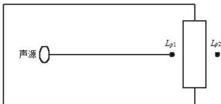
图 4.2-1 室内声源等效为室外声源图例
