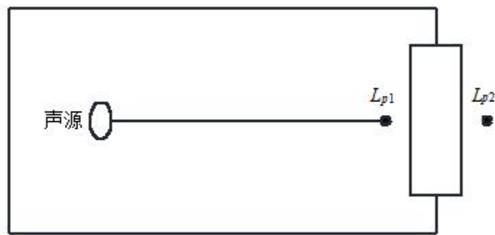
图 4.2-1 室内声源等效为室外声源图例
