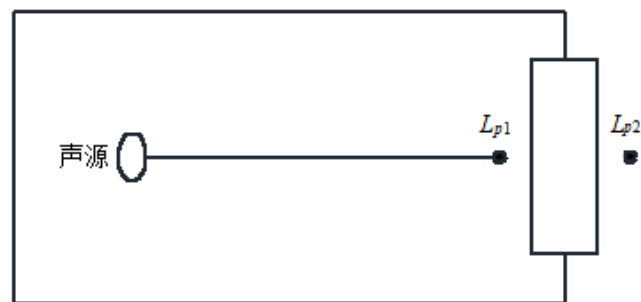
图4.4-1 室内声源等效为室外声源图例
