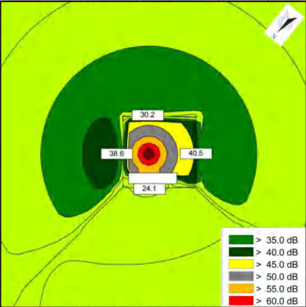
图 4-5 白洋 110kV 变电站本期#1 主变增容后等声值线图 (围墙加高至 2.7m 后, 围墙外 1m, 距地面 1.2m)
