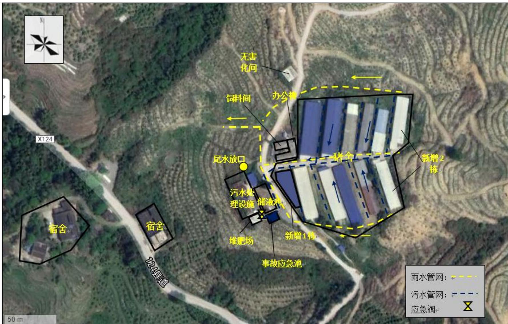
图 3.3-2 全场雨污管线图
