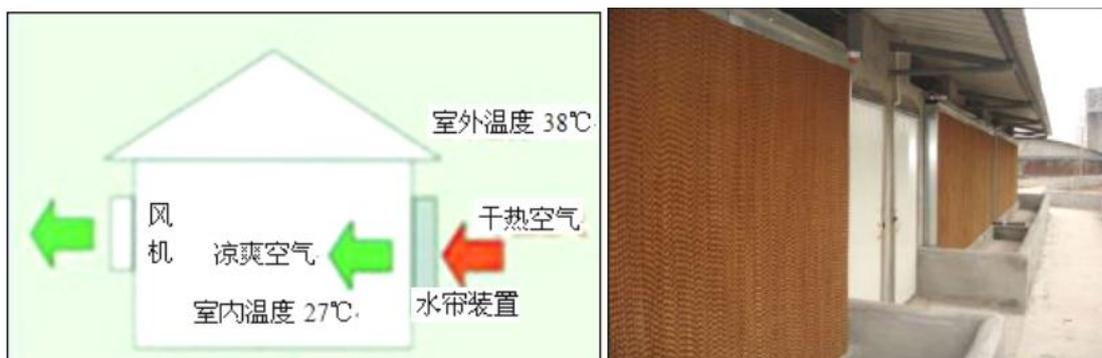
图 7.1-1 水帘处理工艺图与实物参考图
