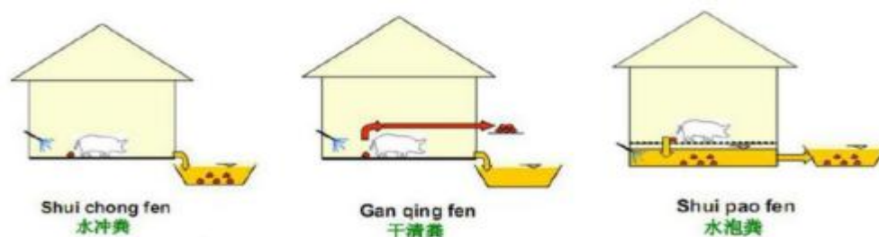
图 10.1-1 水冲粪、干清粪与水泡粪工艺的对比分析
