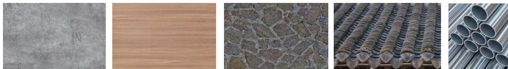
建筑中的主体材料为混凝土、木材、青砖、树脂瓦、青瓦、暗面灰色琉璃瓦构成，辅材为铝合金等。
