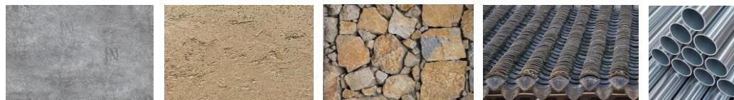
建筑的主体材料为混凝土、木材、仿石砖、树脂瓦、青瓦、暗面灰色琉璃瓦构成，辅材为铝合金等。
