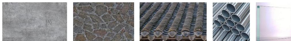
建筑中的主体材料为混凝土、仿石砖、树脂瓦、青瓦、暗面灰色琉璃瓦构成。辅材为铝合金、玻璃等。
