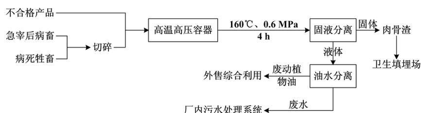
图 6.2-4 湿化法无害化处理工艺
